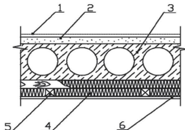
1 – покрытие пола; 2 – цементная стяжка; 3 – плита перекрытия;
