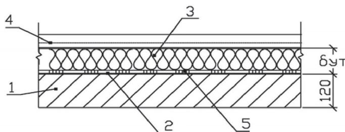
1 – плита перекрытия; 2 – пароизоляционная пленка; 3 – плита теплоизоляционная;
