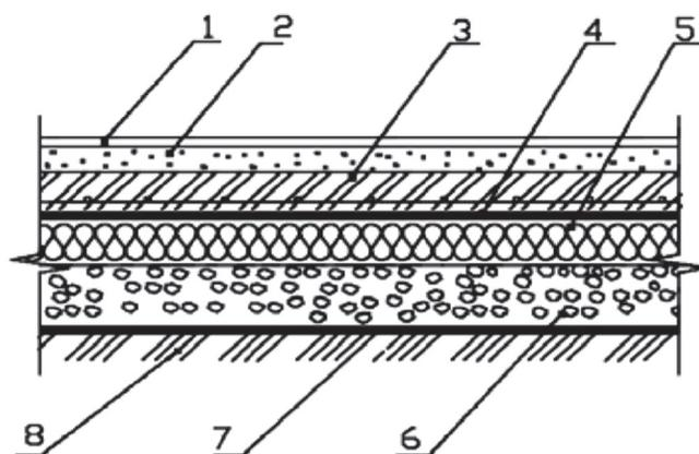
1 – покрытие пола; 2 – цементная стяжка; 3 – армированная бетонная стяжка;
