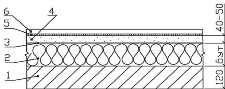
1 – плита перекрытия; 2 – плита теплоизоляционная; 3 – пароизоляционная пленка;
