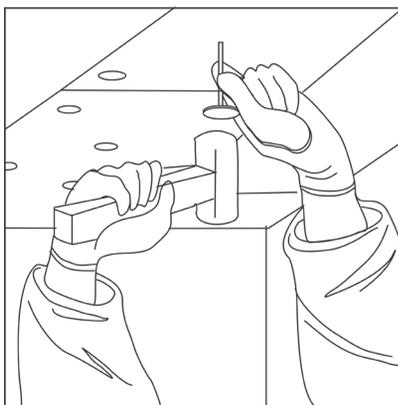
Рисунок 6.7 – Монтаж анкера с использованием молотка металлического
