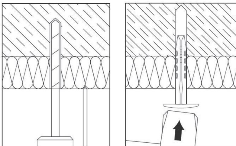
Рисунок 6.6 – Последовательность действий по установке анкера
