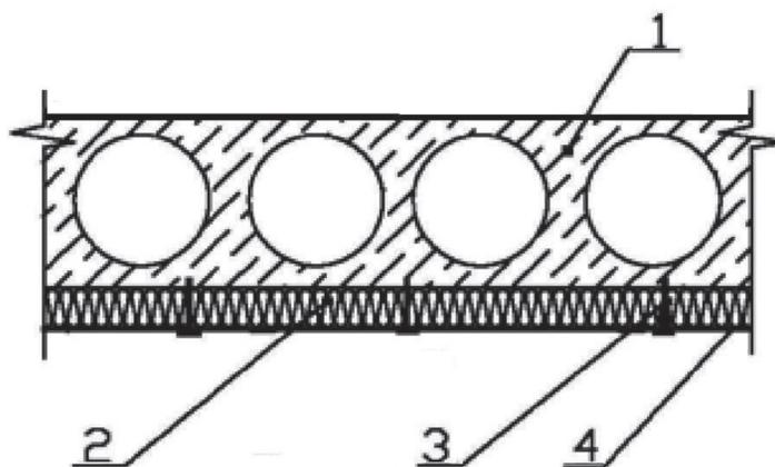
1 – покрытие пола; 2 – цементная стяжка; 3 – плита перекрытия;
