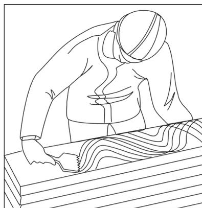
Рисунок 6.10 – Удаление излишков клея с плиты теплоизоляционной шпателем зубчатым
